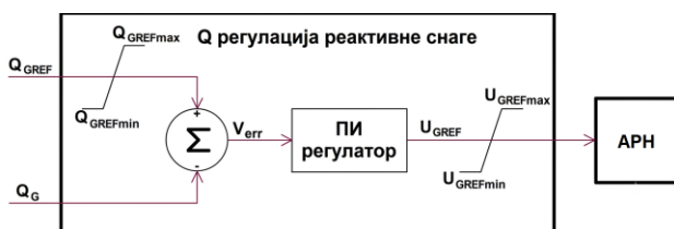
Слика 6. Блок-шема Q регулације реактивне снаге
